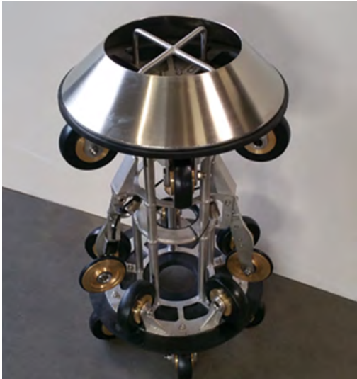
Abbildung 7: Lecksuchmolch mit Aufzeichnungselektronik
